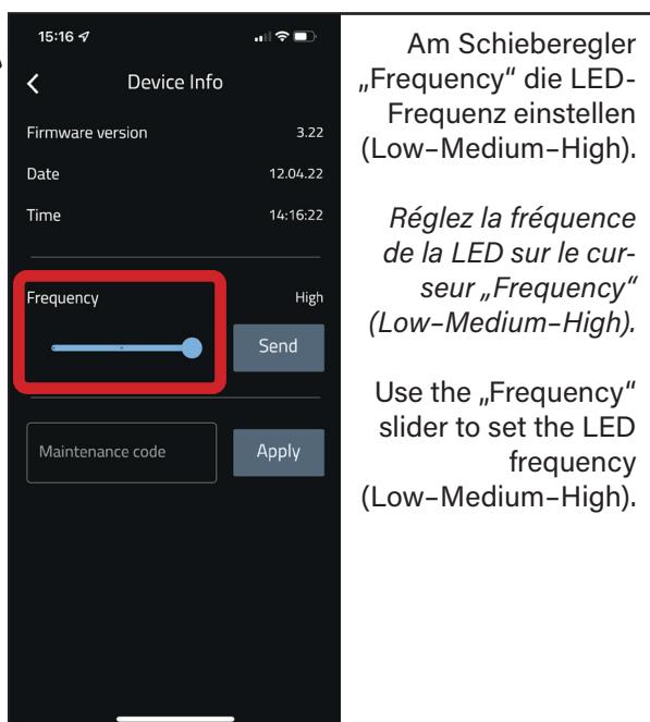
Am Schieberegler „Frequency“ die LED-Frequenz einstellen (Low-Medium-High).
